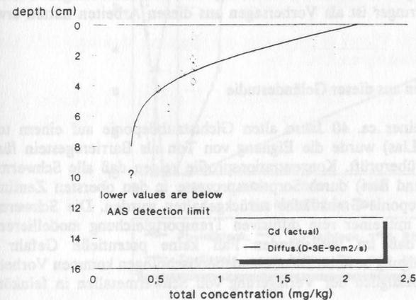
Abb. 8: Kadmiumkonzentration im Ton unterhalb der Deponie, gemessen und berechnet für einen rein diffusiven Transport mit  $t = 40$  Jahre.
