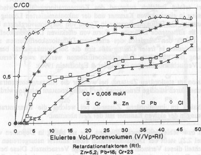
Abb. 4: Durchbruchkurven für Chrom, Blei und Zink in einem illitisch-kaolinitischen Ton ( $k_f = 1,5 \cdot 10^{-10}$  m/s;  $i = 21$ ).
