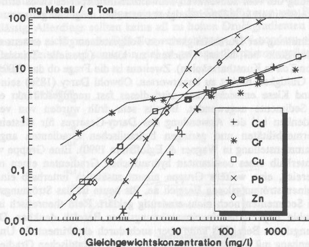
Abb. 3: Adsorptionsisothermen für einen illitisch-kaolinitischen Ton (Ton/Lösung = 1/50; Schüttelzeit 4 Tage).
