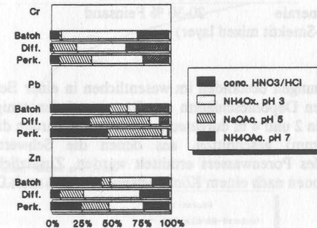
Abb. 6: Schwermetallbindungsformen in einem kaolinitischen Ton. Gegenüberstellung des Batch-, Diffusions- und Perkulationsversuchs bei gleicher Ausgangskonzentration (0,005 M).
