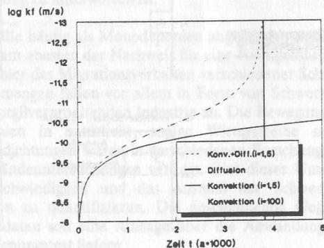
Abb. 2: Migrationszeitzeit (für  $C/C_0 = 0,5$ ) als Funktion von Durchlässigkeitsbeiwert  $k_f$  für den konvektiven und diffusiven Transport von Blei in Ton (effektiver Diffusionskoeffizient  $D = 9 \cdot 10^{-8}$  cm<sup>2</sup>/s; Porosität  $n = 0,5$ ; Weglänge  $l = 1,0$  m).
