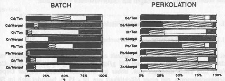
Abb. 5: Schwermetallbindungsformen in Tonen und Mergel (Batch- und Perkulationsversuch) bei hohen Ausgangskonzentrationen ( $10^1$ - $10^2$  M; Legende s. Abb. 6).
