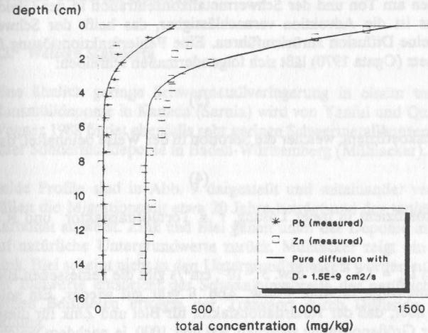
Abb. 7: Blei- und Zinkkonzentration im Ton unterhalb der Deponie, gemessen und berechnet für einen rein diffusiven Transport mit  $t = 40$  Jahre.
